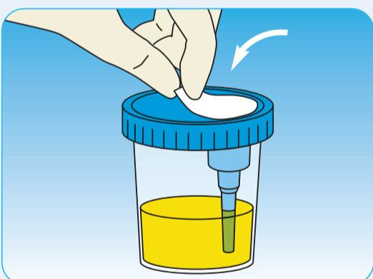
**3 Replacer** l'étiquette autocollante blanche sur l'orifice du couvercle.
